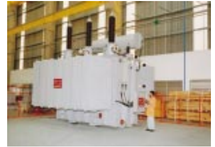
Ujina Termelétrica de Juiz de Fora 50 MVA - Clase 145 kV
